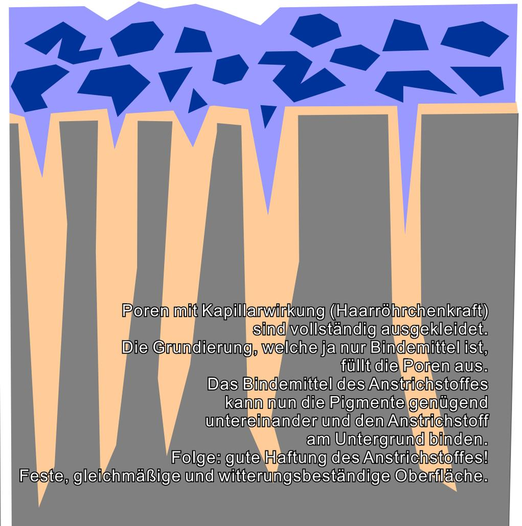
Poren mit Kapillarwirkung (Haarröhrchenkraft) sind vollständig ausgekleidet. Die Grundierung, welche ja nur Bindemittel ist, füllt die Poren aus. Das Bindemittel des Anstrichstoffes kann nun die Pigmente genügend untereinander und den Anstrichstoff am Untergrund binden. Folge: gute Haftung des Anstrichstoffes! Feste, gleichmäßige und witterungsbeständige Oberfläche.
