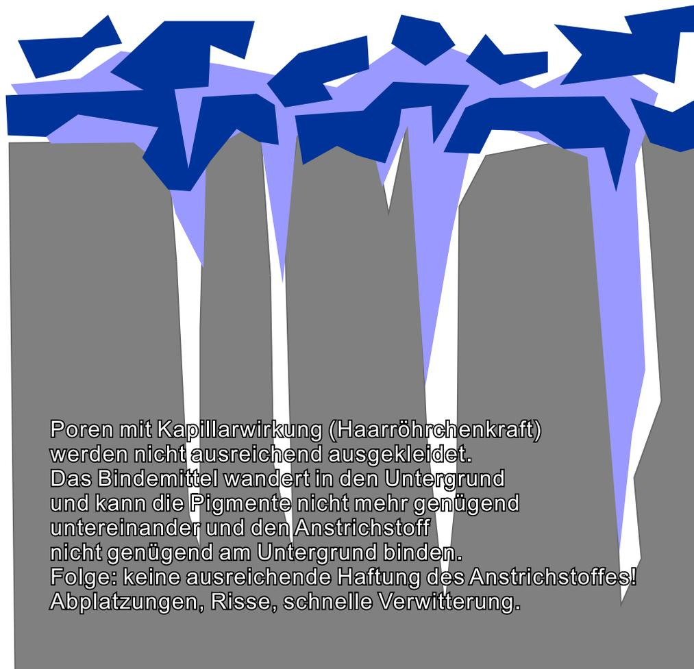
Poren mit Kapillarwirkung (Haarröhrchenkraft) werden nicht ausreichend ausgekleidet. Das Bindemittel wandert in den Untergrund und kann die Pigmente nicht mehr genügend untereinander und den Anstrichstoff nicht genügend am Untergrund binden. Folge: keine ausreichende Haftung des Anstrichstoffes! Abplatzungen, Risse, schnelle Verwitterung.
